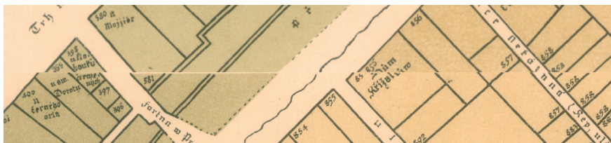
Obr. č. 3. Ukázka nelineárního průběhu chyby v mapové kresbě na okrajích dvou sousedních listů originálního plánu.
